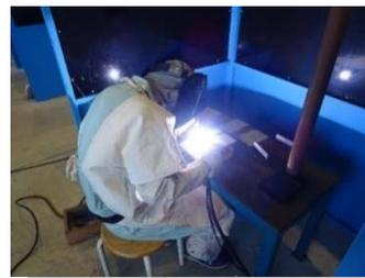
TIG 溶接は、材料が酸化されにくく、高品質であり、ステンレス鋼やアルミニウム合金の溶接など広範囲な金属の溶接が可能な事が特徴です。
