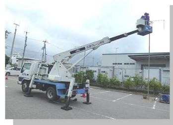
労働安全衛生法では、作業床の高さが10メートル以上の高所作業車の運転（道路上を走行させる運転を除く）業務は、高所作業車運転技能講習修了者でなければ就業できないことになっています。
