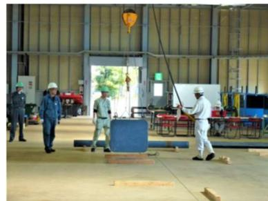
「玉掛け業務」は、ワイヤロープやチェーン及びその他の玉掛け用具を用いて、荷をクレーン等の吊り具に掛けたり外したりする作業をいいます。つり上げ荷重1トン以上のクレーン等の玉掛け業務を行うには、この講習を修了する必要があります。
