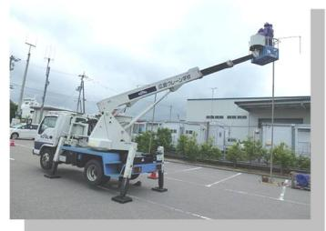
労働安全衛生法では、作業床の高さが10メートル以上の高所作業車の運転（道路上を走行させる運転を除く）業務は、高所作業車運転技能講習修了者でなければ就業できないことになっています。
