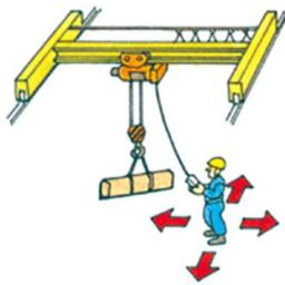
吊り上げ荷重が 5t 以上の床上操作式クレーンは、クレーン運転士免許または床上操作式クレーン運転技能講習修了の資格がなければ、運転の業務に従事することができません。
