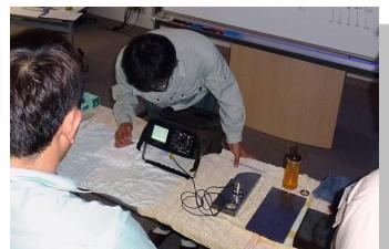
非破壊検査は、材料や機器などを壊さずに、内部の構造や欠陥の有無を調査する技術です。溶接欠陥検査や腐食減肉検査など幅広い分野で使用されています。
